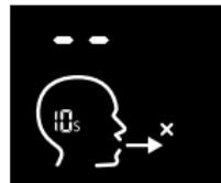
Zaslon prikazuje da izdah nije uspio, treperi crveno LED svjetlo i pojavljuje se zvučni signal.
